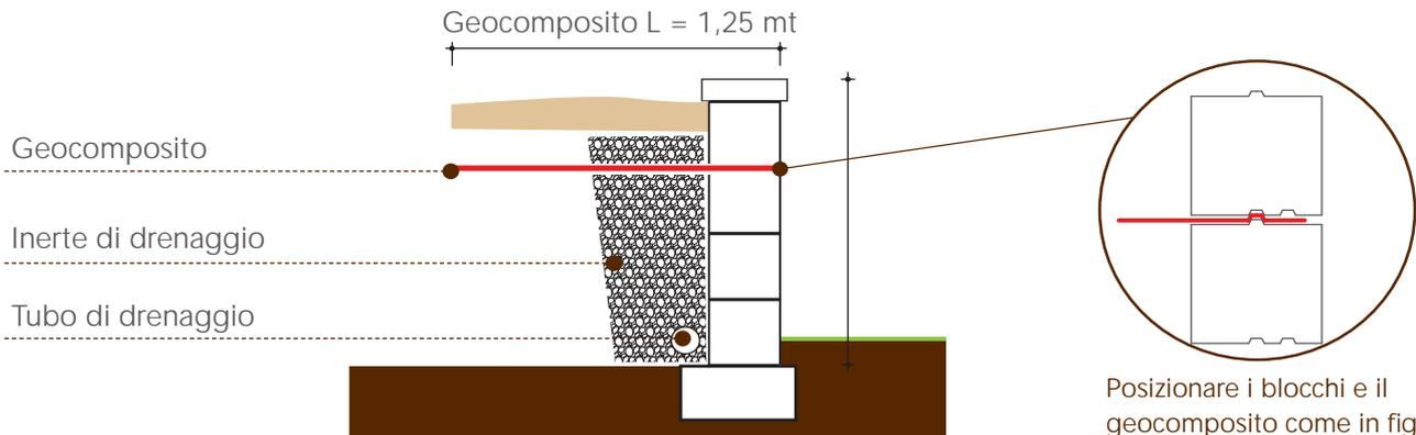
Posizionare i blocchi e il geocomposito come in figura, inserendo il geocomposito ogni 60/70 centimetri ca.
